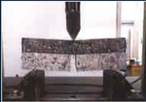
曲げ試験状況
